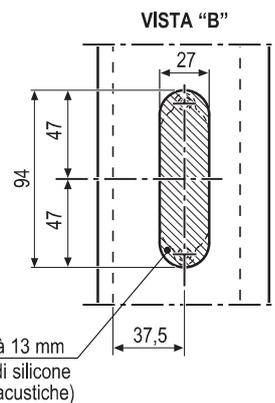
Posizionamento perno di battuta per altezza maniglia a 400 mm
