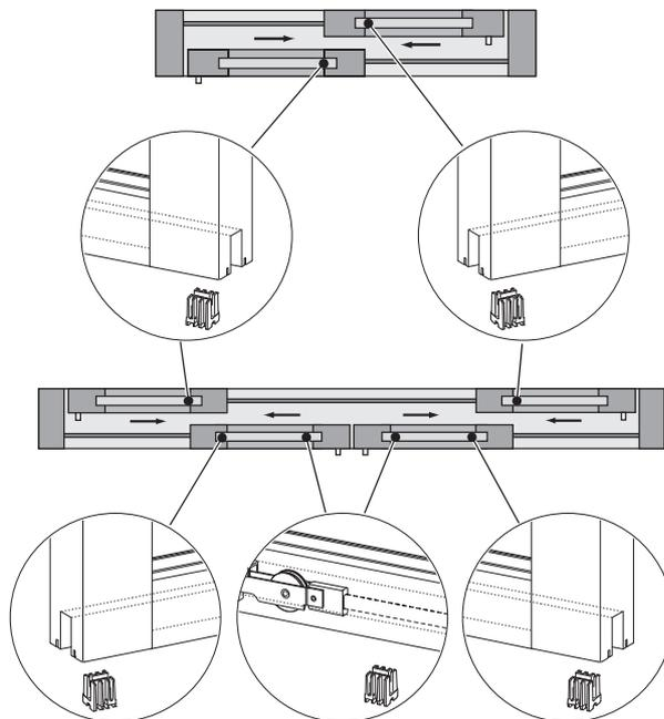
**POSIZIONE TAMPONE INFERIORE POSTERIORE**
